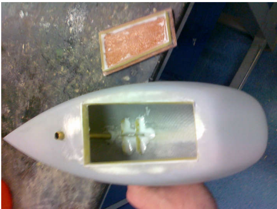
Obrázek 10 Ukotvení kýlu a trubky stěžně v trupu po zalití epoxidem. Poklop na otvor v trupu.
